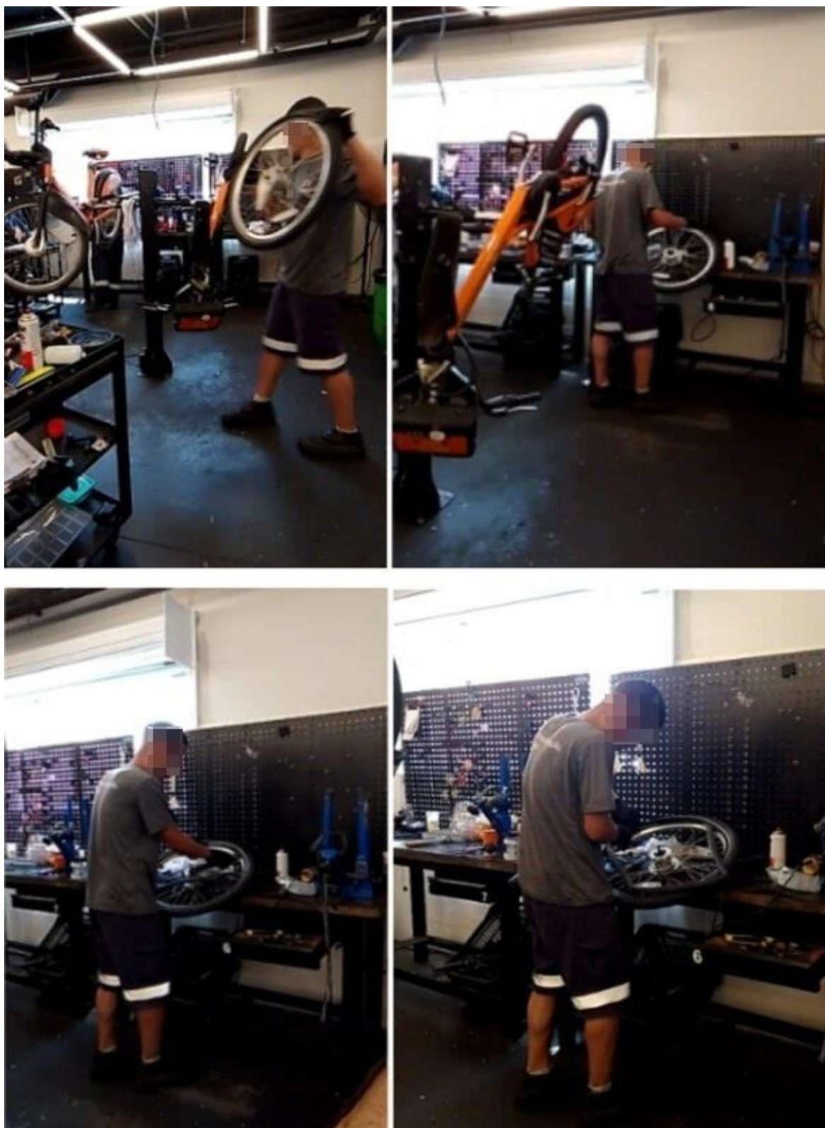
Figura 19 - Fotos do mecânico levando a roda dianteira da bicicleta para a bancada de ferramentas e realizando a troca da câmara de ar furada
