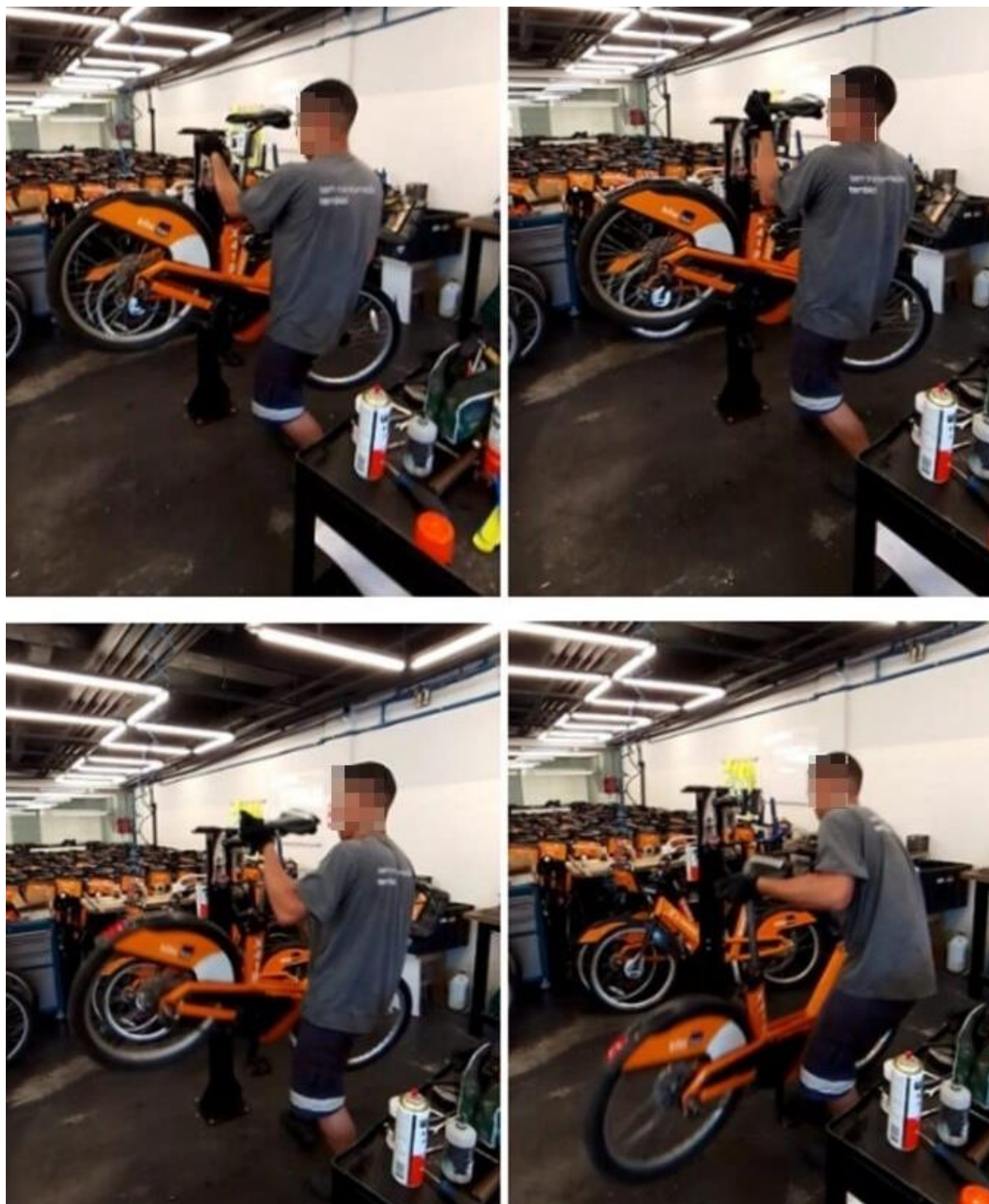
Figura 35 - Fotos do mecânico suportando o peso da bicicleta elétrica em movimento de descida do cavalete
