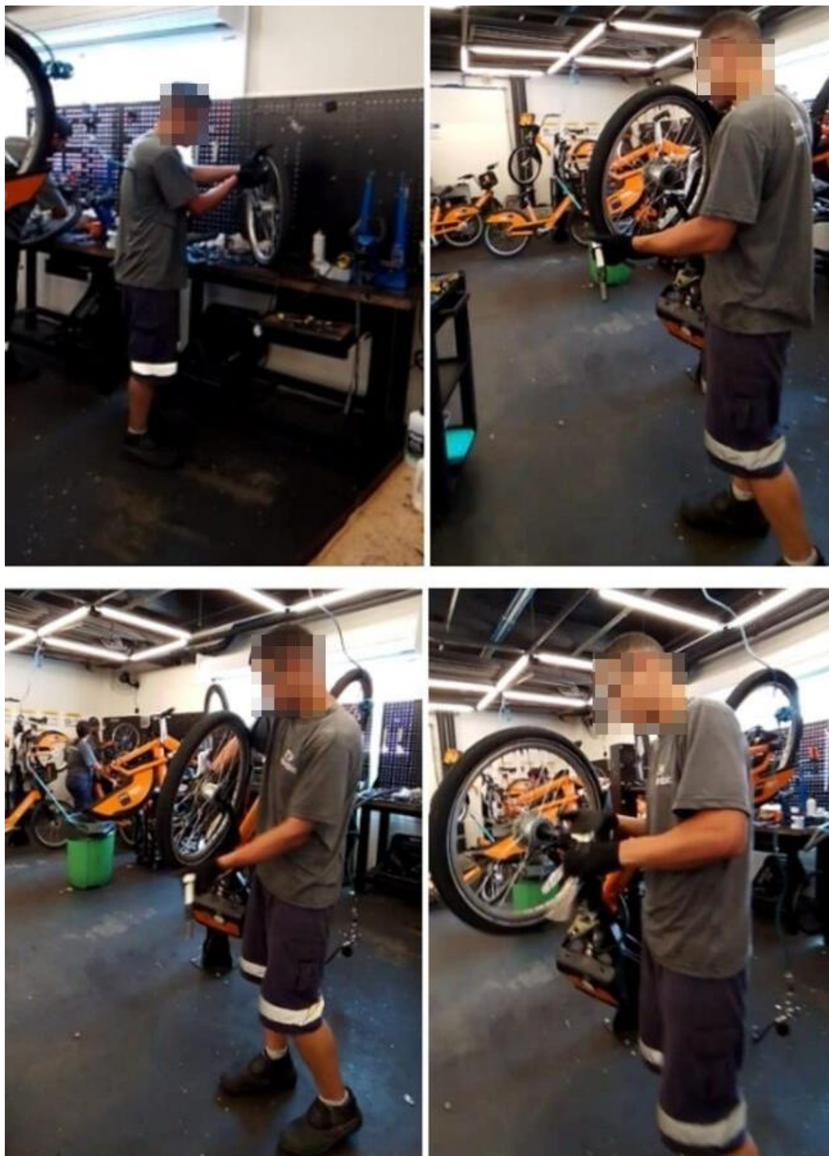
Figura 20 - Fotos do mecânico finalizando a troca da câmara de ar e colocando de volta na bicicleta a roda dianteira reparada
