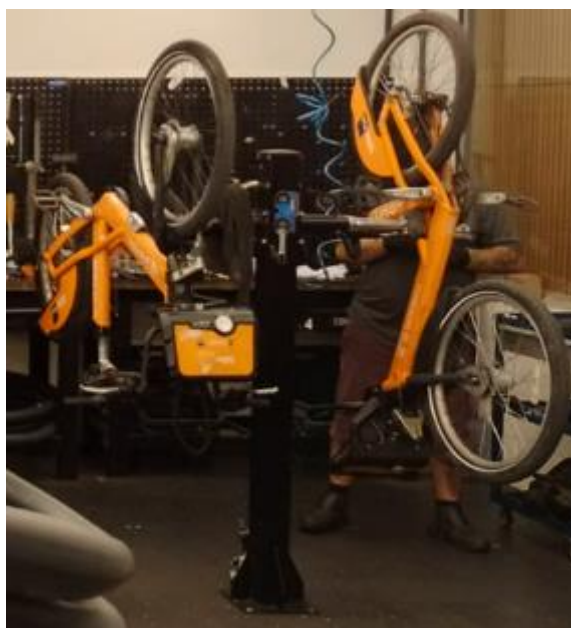
Figura 11 - Foto do cavalete utilizado pelos mecânicos na manutenção de bicicletas
